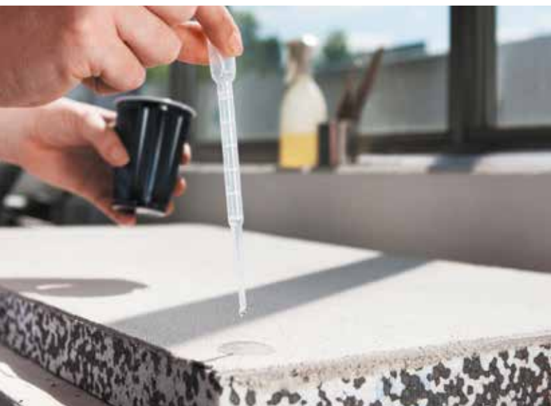
Waterafstotend: de coating van de Capatect-Dalmatiër isolatieplaat blijkt tijdens de test aan de hoge eisen te voldoen.
